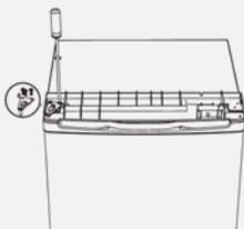
25. Abdeckplatte auflegen und hinten mit den beiden Schrauben befestigen.
