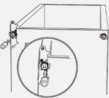
20. Stift des oberen Scharniers in die Vorrichtung der oberen Gerätetür einsetzen.
