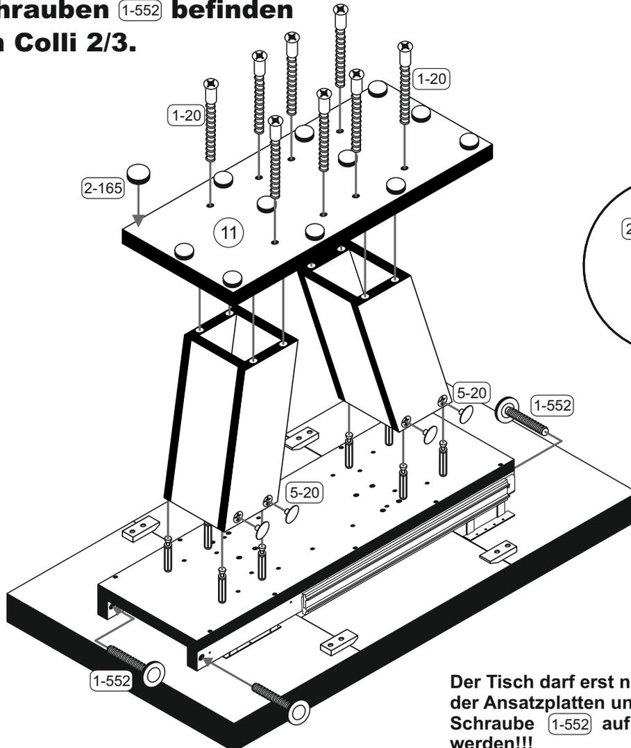
**Der Tisch darf erst nach dem Einschieben der Ansatzplatten und der Fixierung mit der Schraube 1-552 auf den Boden gestellt werden!!!**
