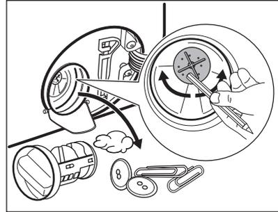
10. Reinigen Sie das Sieb unter fließendem Wasser.
