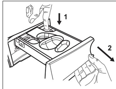
2. Entfernen Sie den Behälter für Flüssigwaschmittel, wenn er eingesetzt ist.
