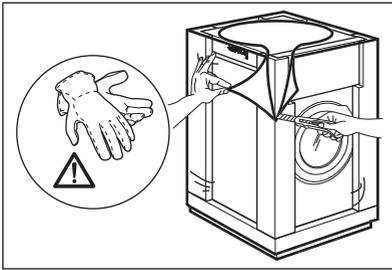
2. Entfernen Sie die Karton-Abdeckung und die Styroporverpackungsteile.
