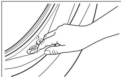
Reinigen Sie sie nach Bedarf mit einer ammoniakhaltigen Reinigungscreme ohne die Oberfläche der Dichtung zu verkratzen.
