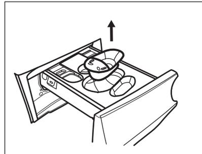
3. Heben Sie die obere Abdeckung der Fächer an, um sie zu entfernen.
