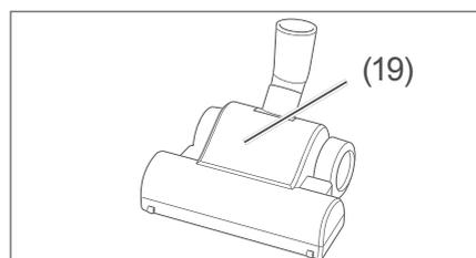
Die rotierende Turbobürste (19) wird durch den Saug-Luftstrom angetrieben. Sie eignet sich besonders für Verschmutzungen wie z. B. Haare und Fäden auf Teppichen und Teppichböden. Stellen Sie beim Einsatz der Turbobürste den Staubsauger auf maximale Saugleistung (siehe
