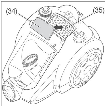
3. Nehmen Sie den Motorschutzfilter (34) aus der Halterung (35), und klopfen Sie ihn über einem Mülleimer aus.
