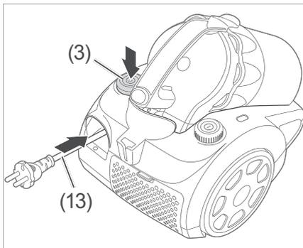
3. Treten Sie zum Aufwickeln des Netzkabels (13) auf den Fußschalter für Kabelaufwicklung (3). Halten Sie dabei das Netzkabel (13) am Netzstecker in der Hand, um einen even-
