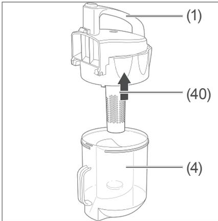
3. Nehmen Sie den Staubbehälterdeckel (2) ab, wie im Abschnitt „Staubbehälter entleeren“ beschrieben (siehe „Staubbehälter entleeren“ auf Seite 20).
