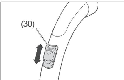
Bei Bedarf können Sie die Saugkraft mithilfe des Nebenluftventils (30) weiter verringern. Die Abdeckung des Nebenluftventils (30) lässt sich stufenlos verschieben.
