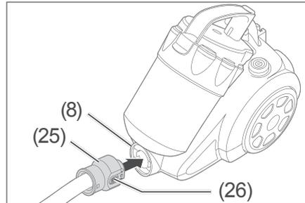
4. Drücken Sie den Sicherungsknopf (26) am Verbindungsstück (25) leicht zusammen, während Sie das Verbindungsstück (25) in die Öffnung (8) stecken.
