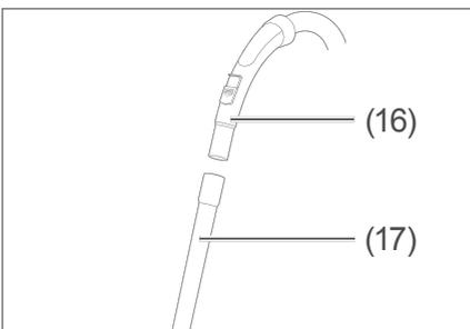
3. Stecken Sie den Saugschlauch (16) und das Teleskoprohr (17) zusammen.
