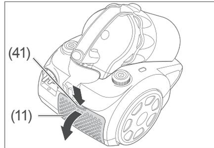
1. Drücken Sie die Verriegelungstaste (41) an der Abdeckung (11) für den Abluftfilter, und nehmen Sie die Abdeckung (11) ab.
