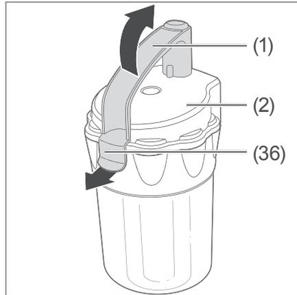
3. Ziehen Sie die Verriegelungstaste (36) nach vorne, und klappen Sie den Staubbehälterdeckel (2) am Tragegriff (1) nach oben.
