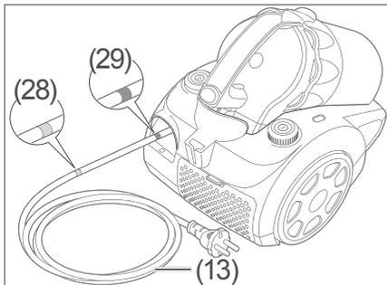
1. Ziehen Sie das Netzkabel (13) heraus, bis die gelbe Markierung (28) auf dem Netzkabel (13) sichtbar wird. Wenn die rote Markierung (29) zum Vorschein kommt, ist das Netzkabel (13) zu weit abgewickelt. Ziehen Sie das Netzkabel (13) etwas ein (siehe „Saugen beenden“ auf Seite 17).
