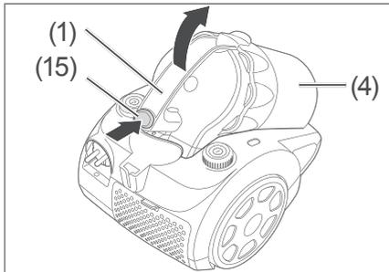
2. Drücken Sie die Verriegelungstaste (15) für den Staubbehälter (4), und heben Sie den Staubbehälter (4) am Tragegriff (1) nach oben aus dem Gerät heraus.
