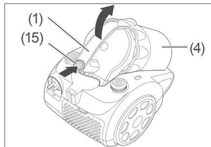
2. Drücken Sie die Verriegelungstaste (15) für den Staubbe-
