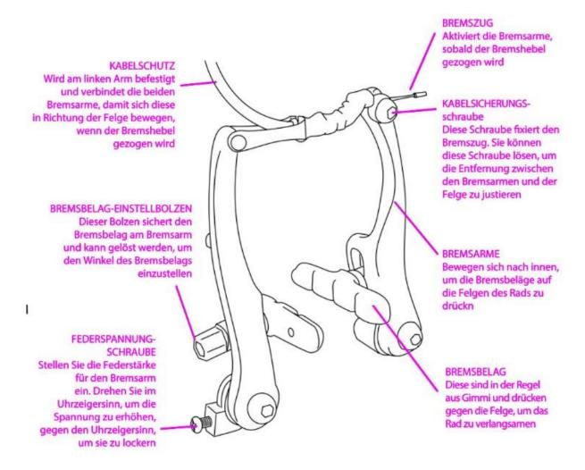
Am Vorder- und Hinterrad sind mechanische Felgenbremsen, sogenannte V-Brakes, montiert. Bei V-Brakes werden die Bremsbacken über einen Seilzug von beiden Seiten gegen die Felge gedrückt, um das Rad abzubremsen. Die Bremsbacken bestehen normalerweise aus Hartgummi und unterliegen einem Verschleiß. Sie betätigen die Bremsen durch die am Lenker montierten Bremshebel.
