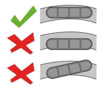
Achten Sie darauf, dass die Stellung der Bremsbeläge der Abbildung links mit dem grünen Haken entsprechen.
