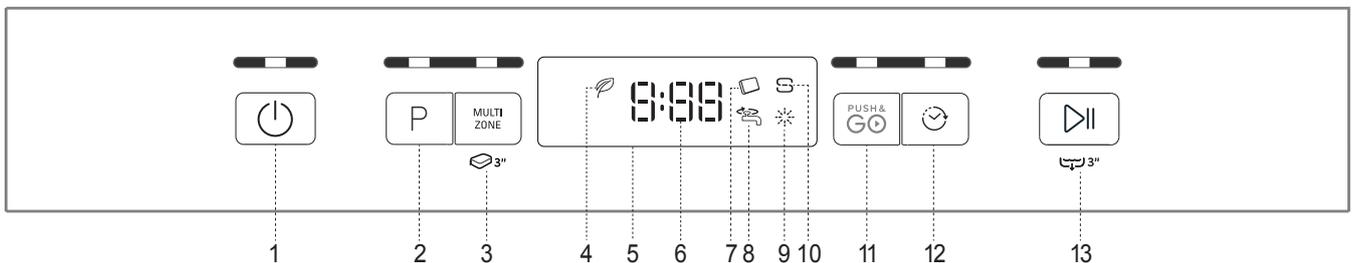
1. Ein-Aus/Reset Taste mit Anzeigelicht
