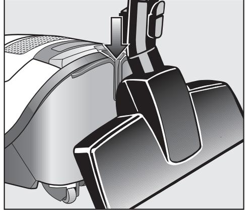
⚠ Beim Saugen – vor allem von Feinstaub, wie z. B. Bohrstaub, Sand, Gips, Mehl usw. – kommt es naturgemäß zu elektrostatischen Aufladungen, die sich entladen können. Um die unangenehme Wirkung der elektrostatischen Entladungen zu vermeiden, ist im oberen, gebogenen Teil des Handgriffs eine Ableitvorrichtung eingearbeitet. Achten Sie beim Saugen darauf, dass Ihre Hand diesen oberen, gebogenen Teil des Handgriffs immer umfasst.
