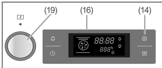
1. Funktion wählen: Drehen Sie den Regler (19), bis das Display (16) das Symbol anzeigt.
