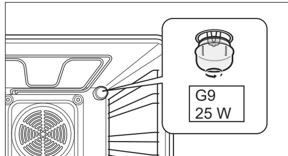
3. Schrauben Sie die Glasabdeckung gegen den Uhrzeigersinn ab und nehmen Sie sie heraus.
