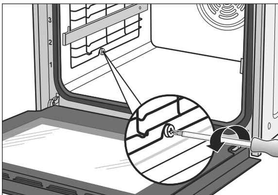
1. Lösen Sie die Schrauben an den Backblechträgern und nehmen Sie sie heraus.
