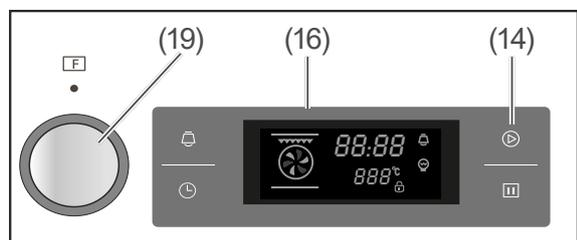
1. Funktion wählen: Drehen Sie den Regler (19), bis das Display (16) das entsprechende Symbol und dessen Standard-Temperatur anzeigt.
