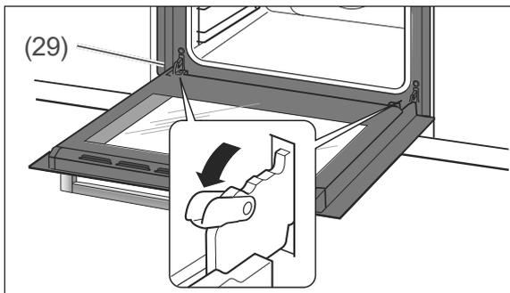
2. Klappen Sie an beiden Seiten die Bügel (29) ganz nach vorne. Nehmen Sie gegebenenfalls einen Schraubendreher zu Hilfe.
