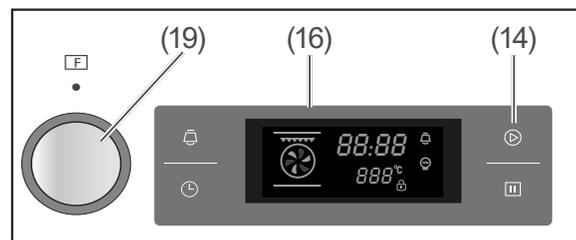
1. Funktion wählen: Drehen Sie den Regler (19), bis das Display (16) das Symbol anzeigt.
