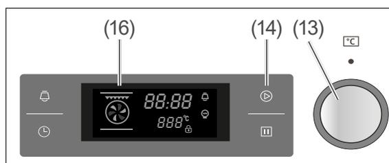
5. Temperatur anpassen: Drehen Sie den Regler (13), bis das Display (16) die gewünschte Temperatur anzeigt.
