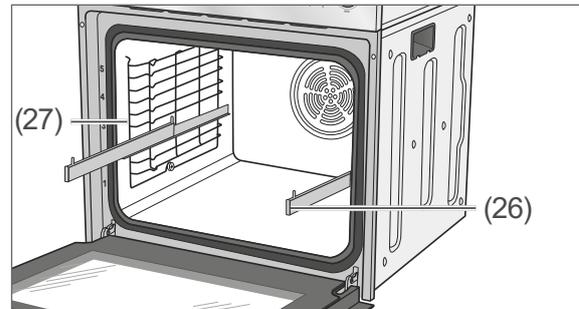
An den Seitenwänden des Garraums befinden sich die Backblechträger (27) mit den ausziehbaren Teleskopschienen (26). Damit lassen sich die Backbleche bequemer herausziehen, z. B. um einen Braten zu begießen.
