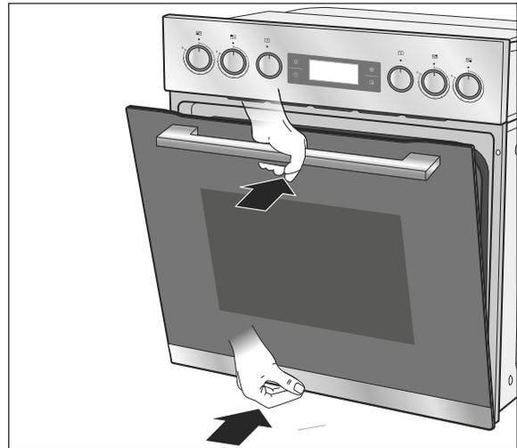
4. Heben Sie die Tür mit beiden Händen leicht an und lassen Sie sie nach vorne herausgleiten.
