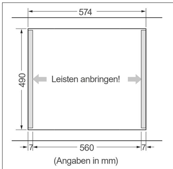
3. Bringen Sie links und rechts im Ausschnitt der Arbeitsplatte Ausgleichleisten an, um eine Breite von 560 mm zu erreichen.
