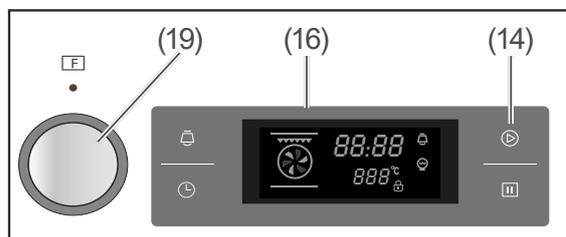
3. Gardauer ändern: Drehen Sie den Regler (19), bis das Display (16) die gewünschte Gardauer anzeigt (0:00 bis 9:00).
