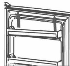
6. Tauwasser-Ablaufloch überprüfen. Regelmäßig mit Hilfe von Wattestäbchen reinigen.
