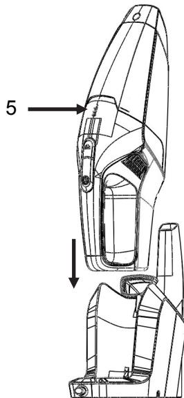
1. Setzen Sie den Akkusauger in die Ladestation.
