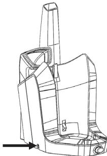
1. Trennen Sie das Rückteil der Ladestation vom Vorderteil ab, indem sie es nach unten schieben. (Abb. 1)
