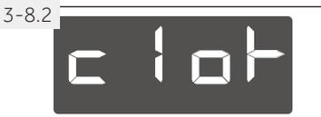
Wird bei aktivierter Kindersicherung eine Taste gedrückt leuchtet **c l o t** im Display auf (Abb. 3-8.2); die Änderung wird nicht ausgeführt.
