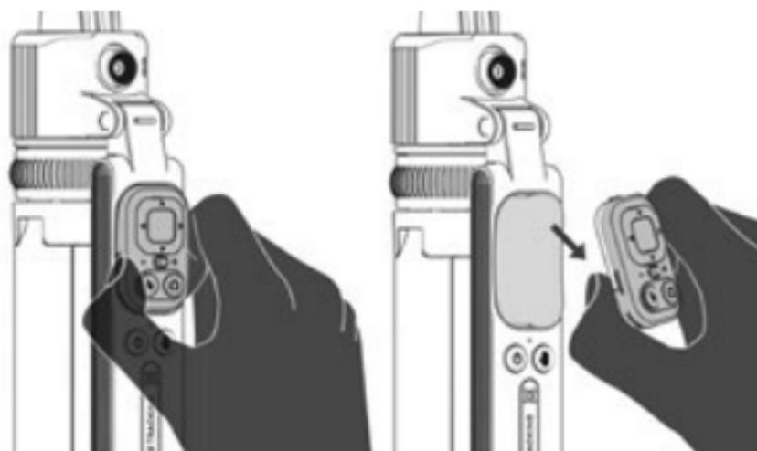
Die Fernbedienung befindet sich in dem Balance-Griff. Ziehen Sie sie einfach heraus.
