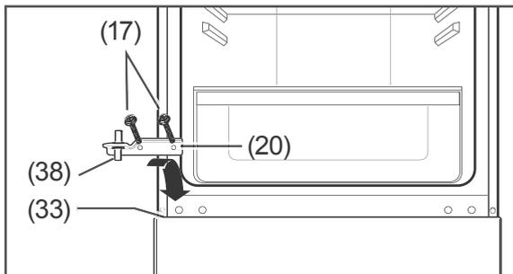
2. Bringen Sie das mittlere Scharnier (20) so wieder an, dass der untere Teil des Stifts (38) in den Einsatz (33) gleitet.
