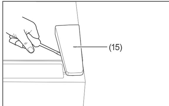
3. Hebeln die Blindplatte (15) an der oberen Tür vorsichtig mit einem Schlitz-Schraubendreher hoch, und nehmen Sie sie ab. Bewahren Sie die Blindplatte gut auf.
