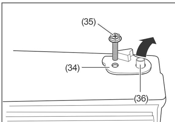
3. Lösen Sie die Schraube (35), und nehmen Sie die Metallverstärkung (34) und die Kunststoffhülse (36) ab.
