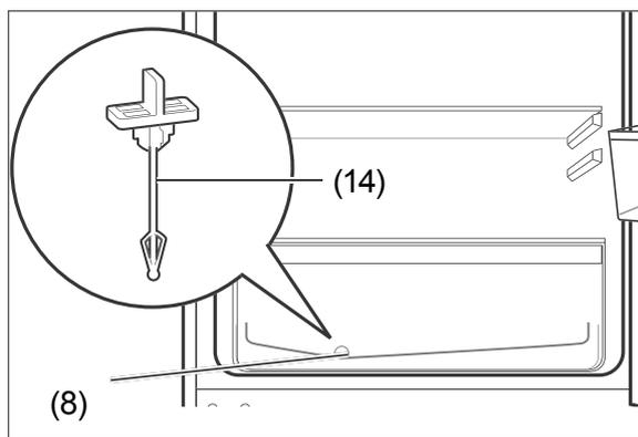
7. An der Rückwand des Kühlbereichs, hinter der Gemüseschublade befindet sich der Tauwasserabfluss (8). Reinigen Sie z. B. mit einem Reinigungswerkzeug (14) den Tauwasserabfluss (8).
