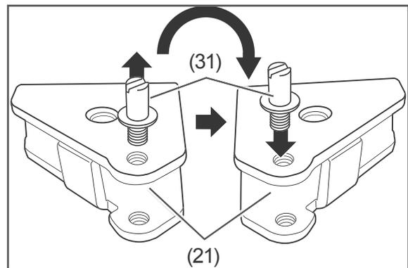
21. Drehen Sie die Stiftschraube (31) heraus, drehen Sie das untere Scharnier (21) um und drehen Sie die Stiftschraube auf der anderen Seite wieder fest.
