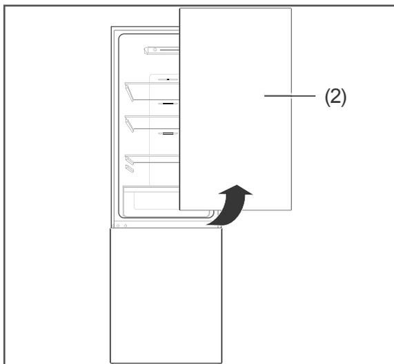
8. Heben Sie die Kühlbereichstür (2) aus dem mittleren Scharnier, und nehmen Sie sie ab.
