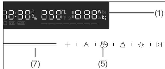
3. Um die Auftaudauer zu verändern, tippen Sie auf den Sensor
