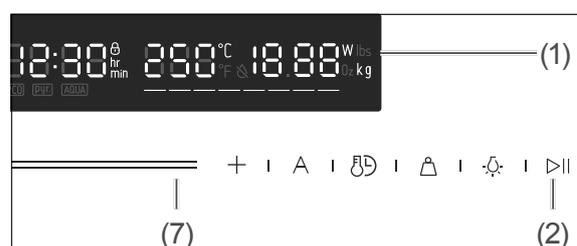
3. Um eine Start-Stunde von 0 bis 23 einzugeben, nutzen Sie die Sensoren +/- oder den Slider (7).
