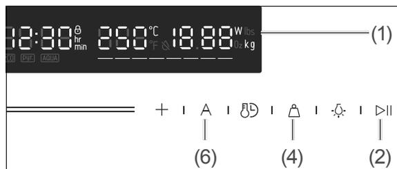
2. Um den Automatik-Betrieb zu wählen, tippen Sie so oft auf den Sensor  $\text{A}$  (6), bis das Display (1) das gewünschte Programm anzeigt.
