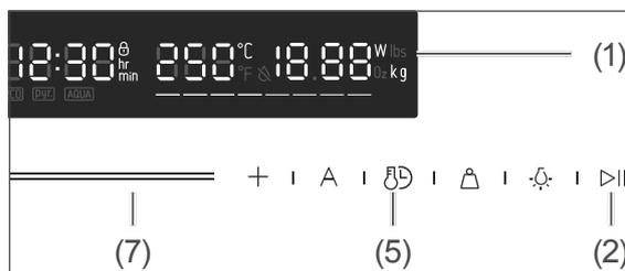
3. Um die Temperatur zu verändern, nutzen Sie die Sensoren +/- oder den Slider (7).
