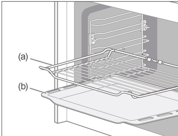
1. Entnehmen Sie den Gitterrost (a) und das Backblech (b).
