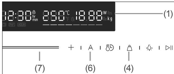
2. Um den Auftaubetrieb nach Gewicht zu wählen, tippen Sie so oft auf den Sensor A (6), bis das Display  $\text{d}00\text{I}$ ,  $\text{d}002$  oder  $\text{d}003$  zeigt.
