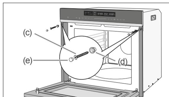
3. Wenn der Backofen richtig ausgerichtet ist, öffnen Sie die Backofentür und schrauben Sie ihn mit dem beiliegenden Montagematerial am Einbauschrank fest. Verwenden Sie die Abstandhalter (d), die Schrauben (c) und die Blindstopfen (e)
