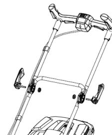
Achten Sie beim Hochklappen darauf, dass keine Kabel abgeknickt oder beschädigt werden!
