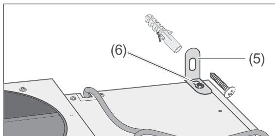
1. Schrauben Sie die beiden Befestigungswinkel (5) mit den Schrauben (6) in die Aussparungen auf der Oberseite der Dunstabzugshaube.
