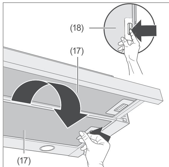
3. Lösen Sie die Verriegelung (18) der Fettfilter (17), und entnehmen Sie die Fettfilter (17) vorsichtig nach unten.
