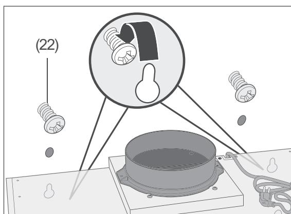
2. Schrauben Sie die beiden Rundkopfschrauben à 4 x 30 für die Schlüssellochöffnungen (22) zum Aufhängen der Dunstabzugshaube in die Dübel. Zwischen Wand und Schraubenkopf muss ausreichend Platz bleiben, damit die Dunstabzugshaube mit den Schlüssellochöffnungen aufgehängt werden kann.
