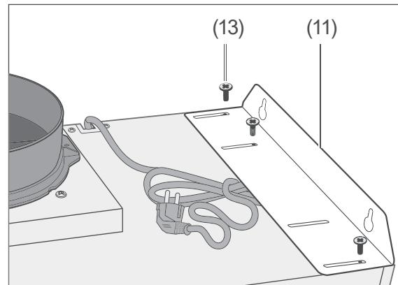
1. Drehen Sie die sechs Schrauben (13) durch die Haltebleche (11) in die vorgesehenen Öffnungen der Dunstabzugshaube. Drehen Sie sie nicht zu fest, die Haltebleche müssen verschiebbar bleiben.
