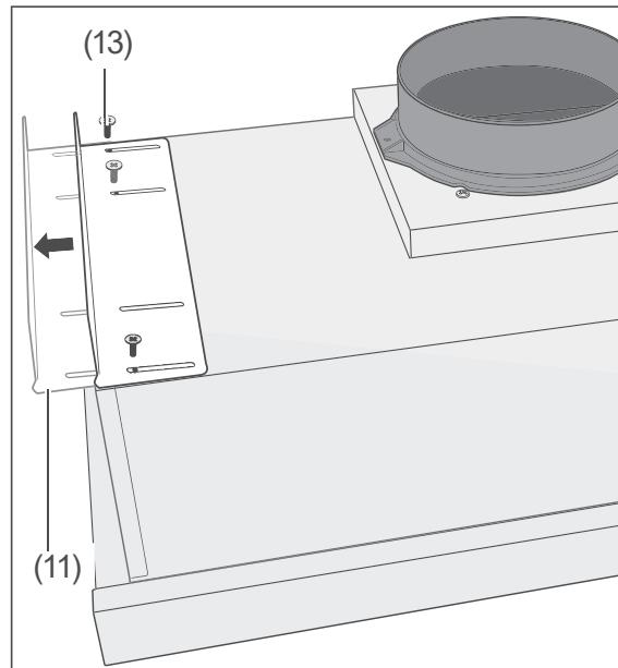
3. Justieren Sie die Dunstabzugshaube, so dass sie mittig in der Nische sitzt und ziehen Sie die sechs Schrauben (13) fest. Die Dunstabzugshaube ist montiert.
