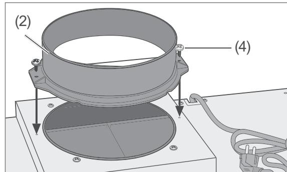
Gleich ob die Dunstabzugshaube an der Wand oder in einem Hängeschrank angebracht werden soll, die Kunststoff-Halterung mit Rückschlagklappe muss montiert werden.
