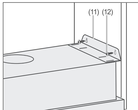
2. Positionieren Sie die Dunstabzugshaube an der gewünschten Position und schrauben Sie die beiden Halbleche (11) mit den vier Schrauben (12) an den Seitenwänden der Nische fest.
