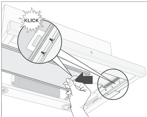
5. Setzen Sie einen Fettfilter mit den Zapfen in die Aussparungen auf der linken Seite.
