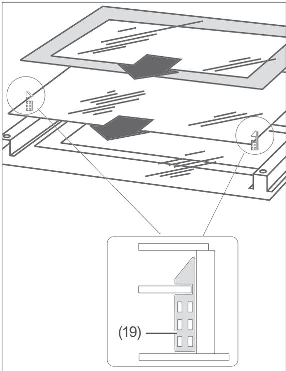
4. Nehmen Sie die obere Scheibe aus der Halterung unten am Scharnier heraus und legen Sie sie sicher ab.
