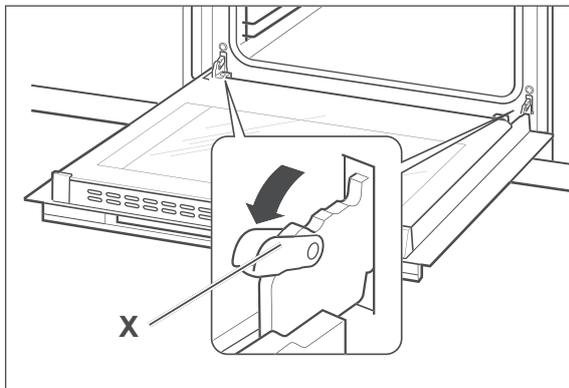
2. Klappen Sie an beiden Seiten die Bügel X ganz nach vorne. Nehmen Sie gegebenenfalls einen Schraubendreher zu Hilfe.
