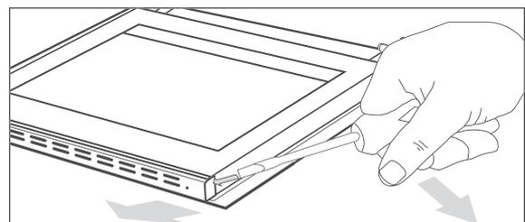
2. Entfernen Sie die beiden Schrauben, die das obere Gitterblech fixieren.
