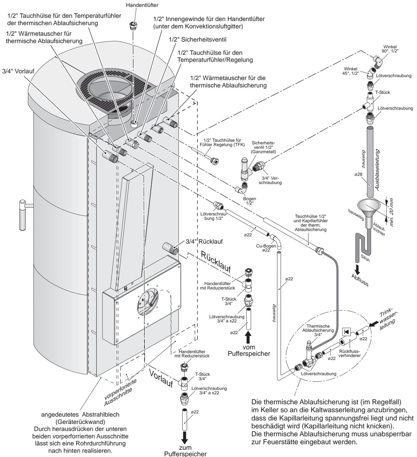
Die thermische Ablaufsicherung ist (im Regelfall) im Keller so an die Kaltwasserleitung anzubringen, dass die Kapillarleitung spannungsfrei liegt und nicht beschädigt wird (Kapillarleitung nicht knicken). Die thermische Ablaufsicherung muss unsperrbar zur Feuerstätte eingebaut werden.
