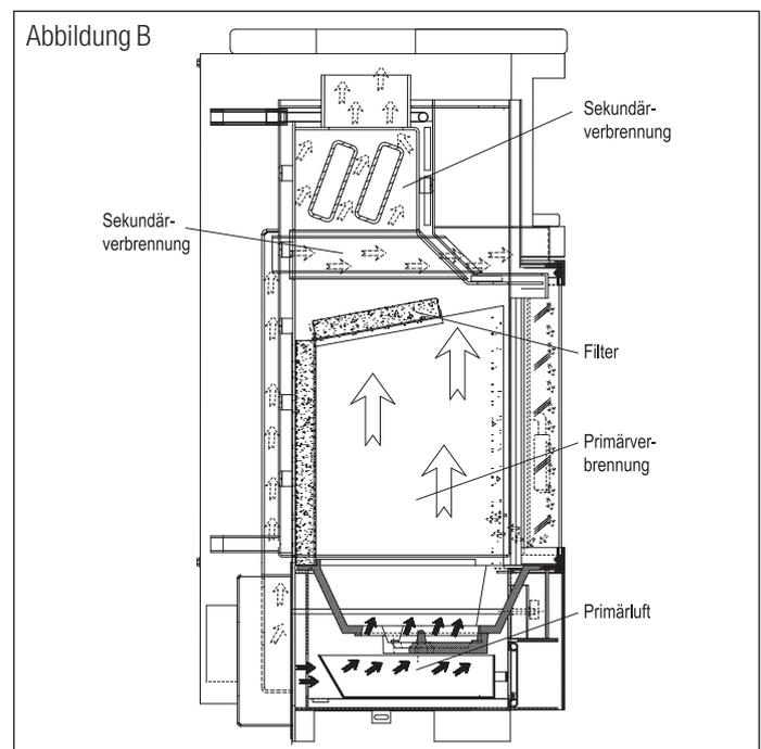
Bitte beachten Sie, dass die Verbrennungsluftleitung und das Gitter in der Außenwand regelmäßig auf Verunreinigungen zu prüfen sind. Laubreste, Pollen oder Spinnenweben können die Verbrennungsluftleitung derart zusetzen, dass der Feuerstätte nicht mehr genügend Verbrennungsluft zugeführt wird und es somit zu erheblichen Funktionsbeeinträchtigungen kommen kann.
