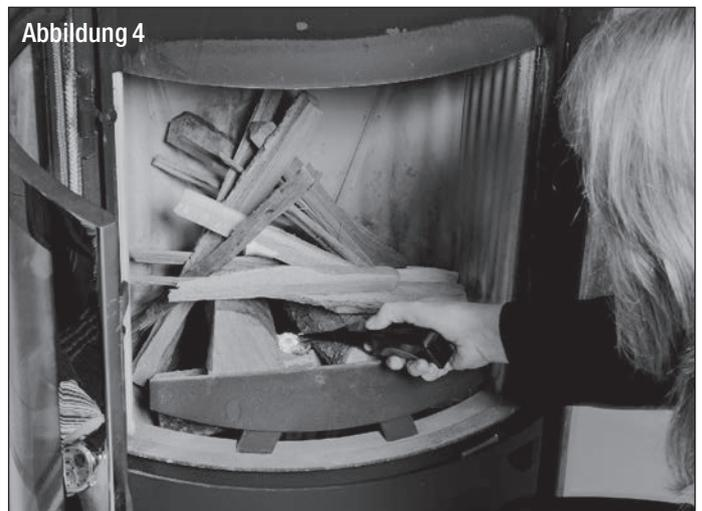
Lassen Sie diese Holzaufgabe mit geöffneten Verbrennungsluftreglern herunterbrennen, bis eine Grundglut vorhanden ist (Abb. 5). Je nach Holzgüte, Schornsteinzug und Witterung dauert diese Verbrennungsphase unterschiedlich lange.
