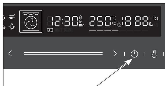
1. Tippen Sie auf den Sensor
