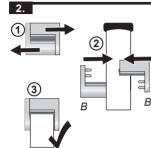
Die Bürstendichtung auseinanderziehen. Den Gurt zwischen den Bürsten nach vorne einfädeln und die Dichtung wieder zusammenstecken.
